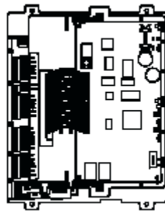
Tracer AH541 montado em quadro
